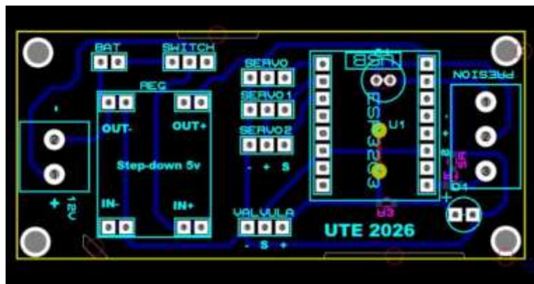
Figura 10. Diseño de pistas y distribución de componentes (Layout) de la PCB de la Base.
