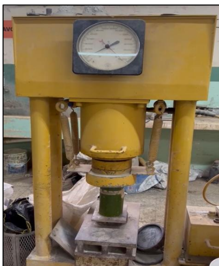
Figura 9. Ensayo a la compresión
