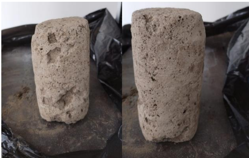
Ilustración 1 Muestras Cilíndricas de Cangahua
