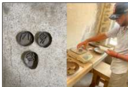
Figura 3. Preparación y pesado de muestras para límite plástico.
