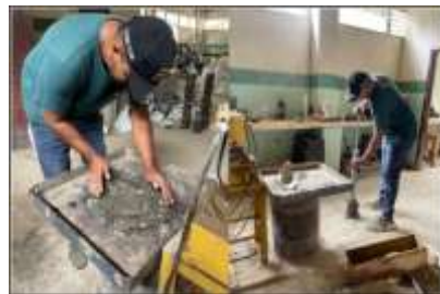
Figura 4. Compactación de muestras de ripio
