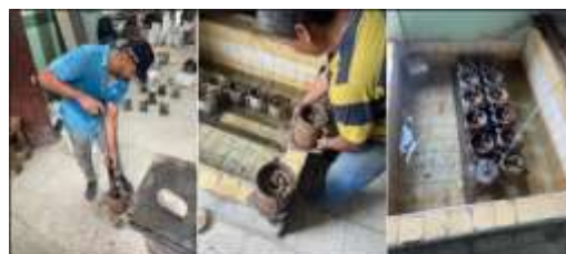
Figura 5. Proceso de compactación e inmersión muestras para ensayo CBR
